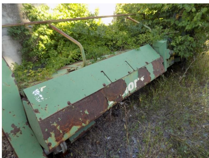
4. Adapter Krone 7500 – Korozija na adapteru
