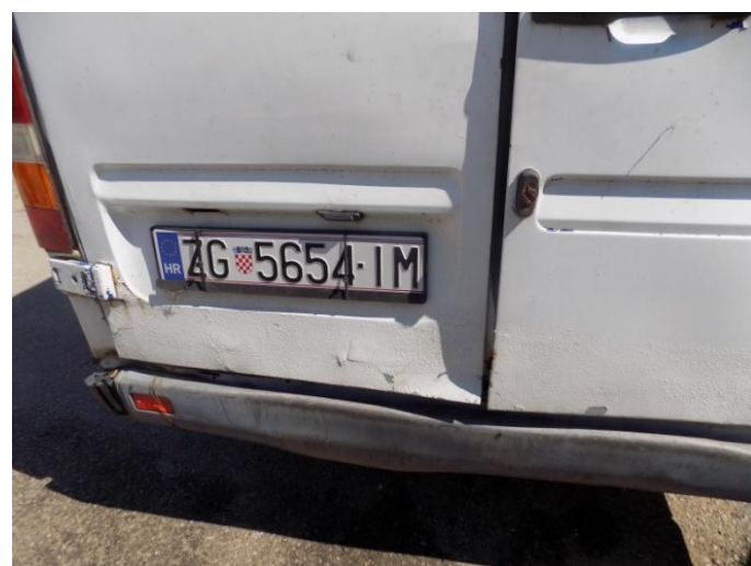
4. Mercedes Sprinter – oštećenje zadnjeg dijela
